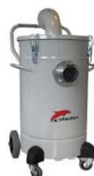
۲۱- مخزن رابط برای جمع آوری مواد بسیار داغ یا حتی گداخته این مخزن با آب پر می‌شود تا در زمان جمع آوری مواد گداخته یا بسیار داغ آها ابتدا وارد آب شوند و سپس گرد و غبار ناشی از آها به همراه هواز مخزن خارج و به سمت جارو حرکت می‌کنند.
