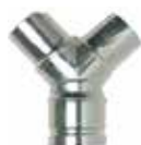
۱۹ - انشعاب دهنه جارو برای استفاده همزمان انشعاب دو دهانه برای مدل‌هایی که سرعت مکش بالایی دارند مناسبتر است چرا که علیرغم تقسیم هوا به دو دهانه همچنان حجم کافی هوا را برای هر دو کاربر تضمین می‌کند.
