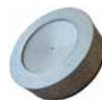
۲۰ - فیلتر هپا با قابلیت جداسازی ذراتی به کوچکی ۰/۳ میکرون این نوع فیلتر به عنوان فیلتر ثانویه در بالای فیلتر اصلی در جاروها نصب می‌شود و در مواردی که دانه بندی مواد بسیار ریز است به نحوی که کوچکتر از یک میکرون باشند می‌تواند کاربرد فراوان داشته باشد.
