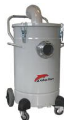
۲۱ - مخزن رابط برای جمع‌آوری مواد بسیار داغ یا حتی گداخته این مخزن با آب پر می‌شود تا در زمان جمع‌آوری مواد گداخته یا بسیار داغ، آنها ابتدا وارد آب شوند و سپس گرد و غبار ناشی از آنها به همراه هوا از مخزن خارج و به سمت جارو حرکت می‌کنند.
