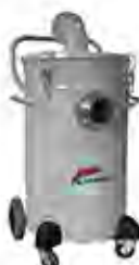
۲۱- مخزن رابط برای جمع آوری مواد بسیار داغ یا حتی گذاشته این مخزن با آب پر می شود تا در زمان جمع آوری مواد گذاشته یا بسیار داغ، آنها ابتدا وارد آب شوند و سپس گرد و غبار ناشی از آنها به همراه هوا از مخزن خارج و به سمت جارو حرکت می کنند.
